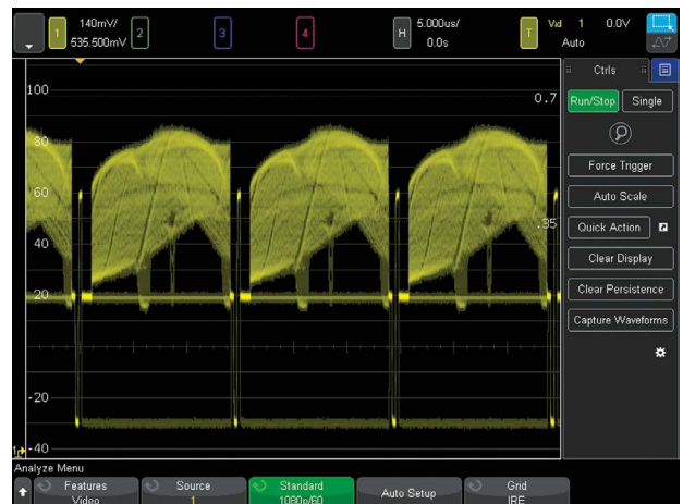
Рис. 27. Синхронизация по сигналу HDTV формата 1080p.
